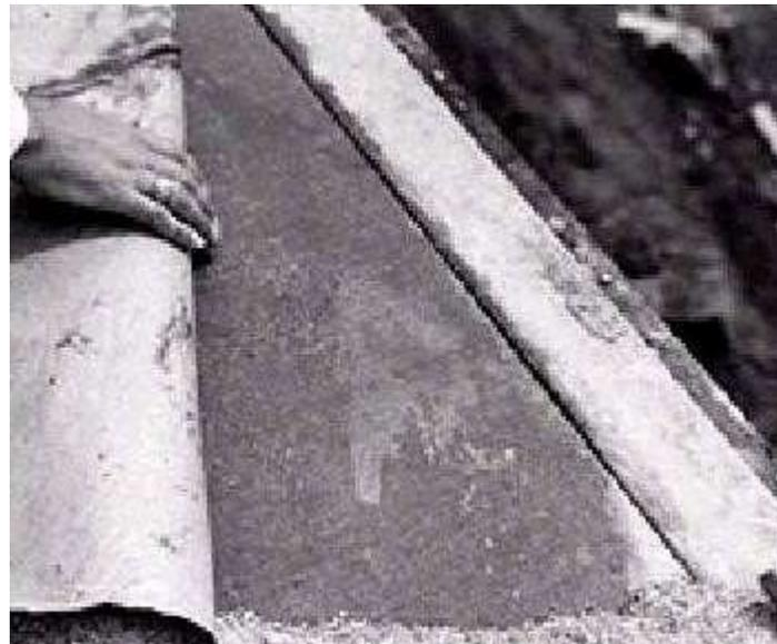
Consiste en dos láminas de papel kraft, ligadas con un adhesivo bituminoso reforzado con fibras
